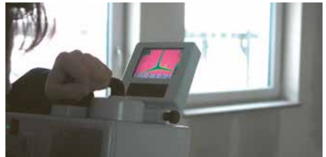
Thermografie – Methodik zur Aufdeckung von Wärme- bzw. Kältebrücken
